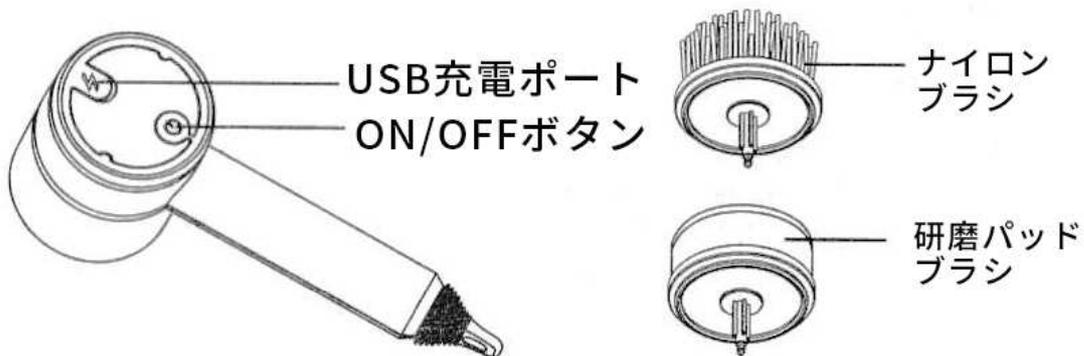
ON/OFF ボタンをダブルクリックすると低速で動作を開始します。
